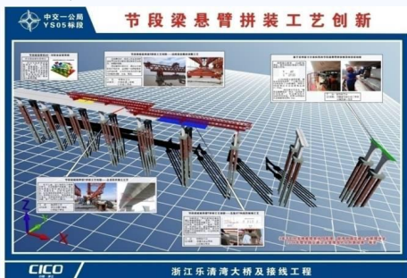
节段梁预制悬拼工艺
