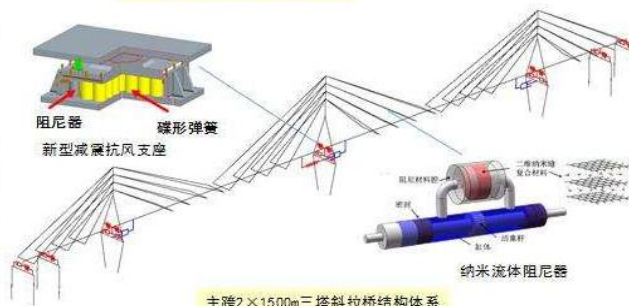
主跨2×1500m三塔斜拉桥结构体系
