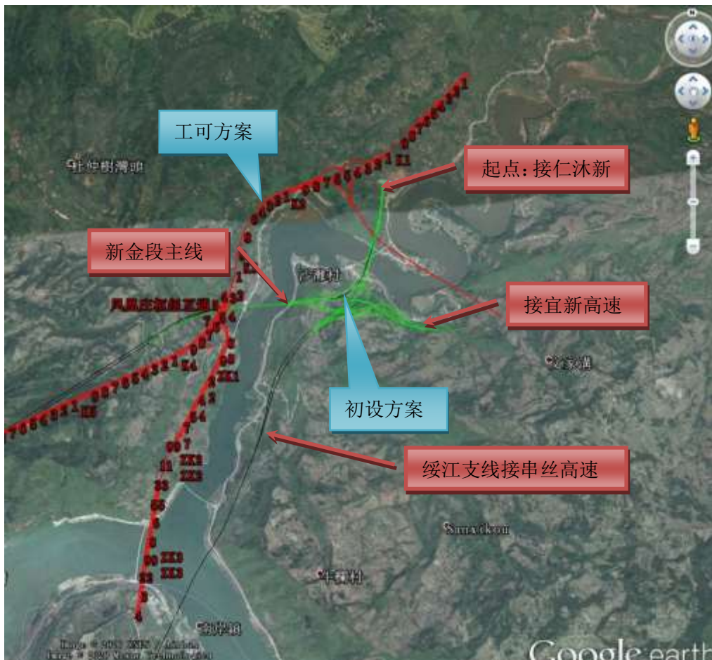
图 3.2-2 工可起点方案与初设起点互通方案对比示意图
