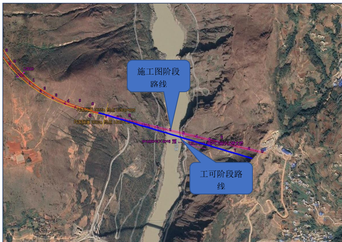
图图 2.3-10 跨省界路段环评和施工图路线方案对比
