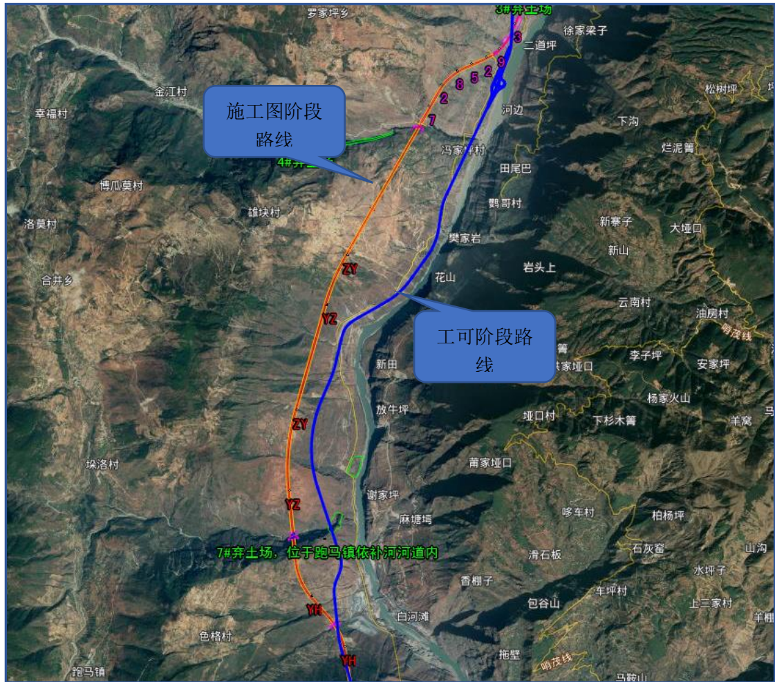
图图 2.3-6 K215+100~K227+920 路段环评和施工图路线方案对比
