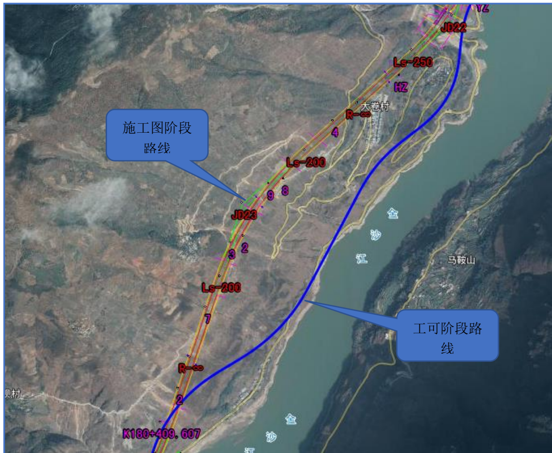
图 2.3-3 K177+690~K179+880 路段环评和施工图路线方案对比
