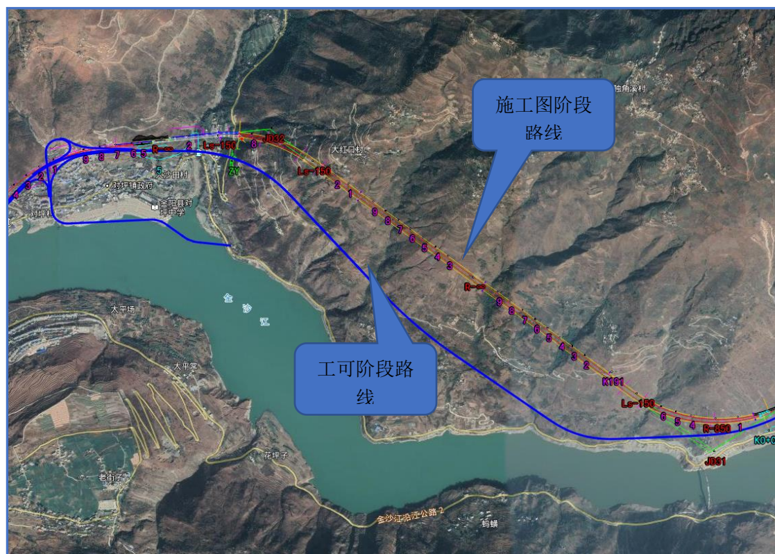
图 2.3-4 K190+680~K193+700 路段环评和施工图路线方案对比
