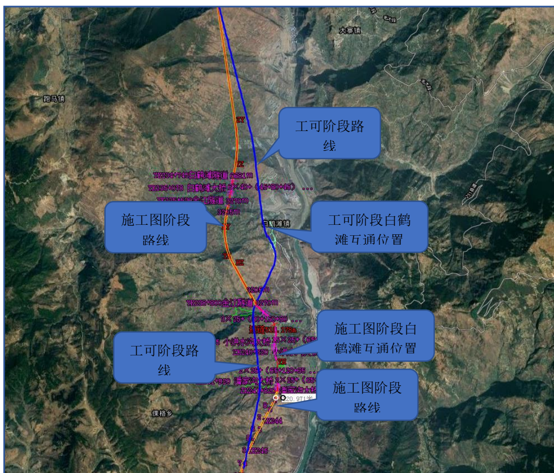
图图 2.3-7 K231+390~K244+100 路段环评和施工图路线方案对比
