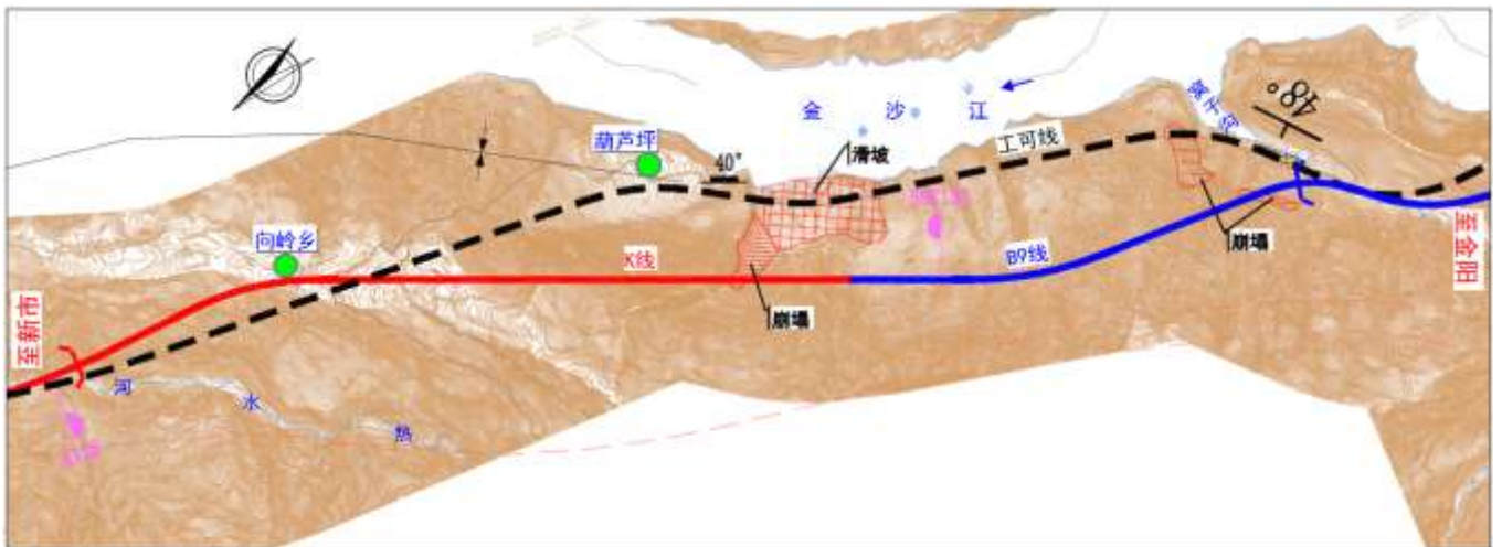
图 2.3-10 主线葫芦坪至窝子沟段工可方案与初设推荐方案对比图
