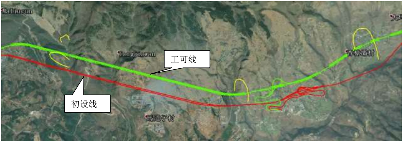
图 2.3-5 主线香樟坝至汶水段工可方案与初设推荐方案对比图
