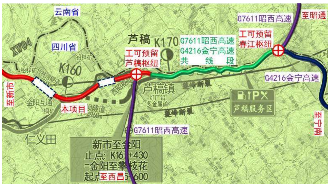
图 3.2-3 工可阶段 G4216 和 G7611 在芦稿至春江段共线方案示意图
