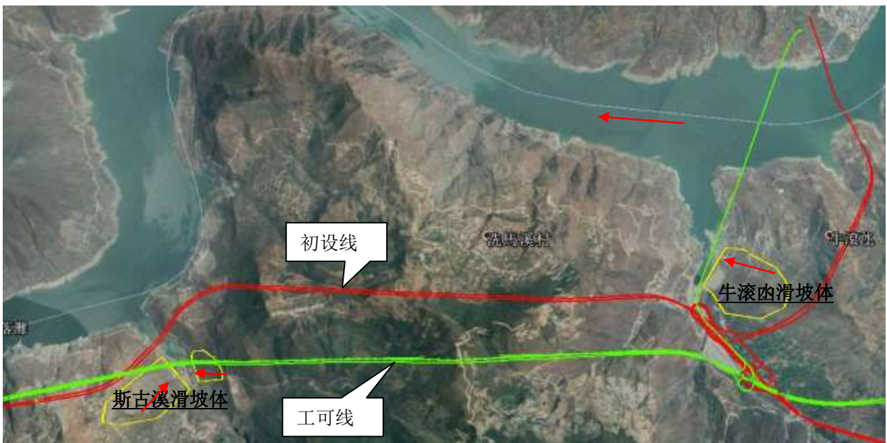
图 2.3-8 斯古溪至卡哈洛段工可方案与初设推荐方案对比图
