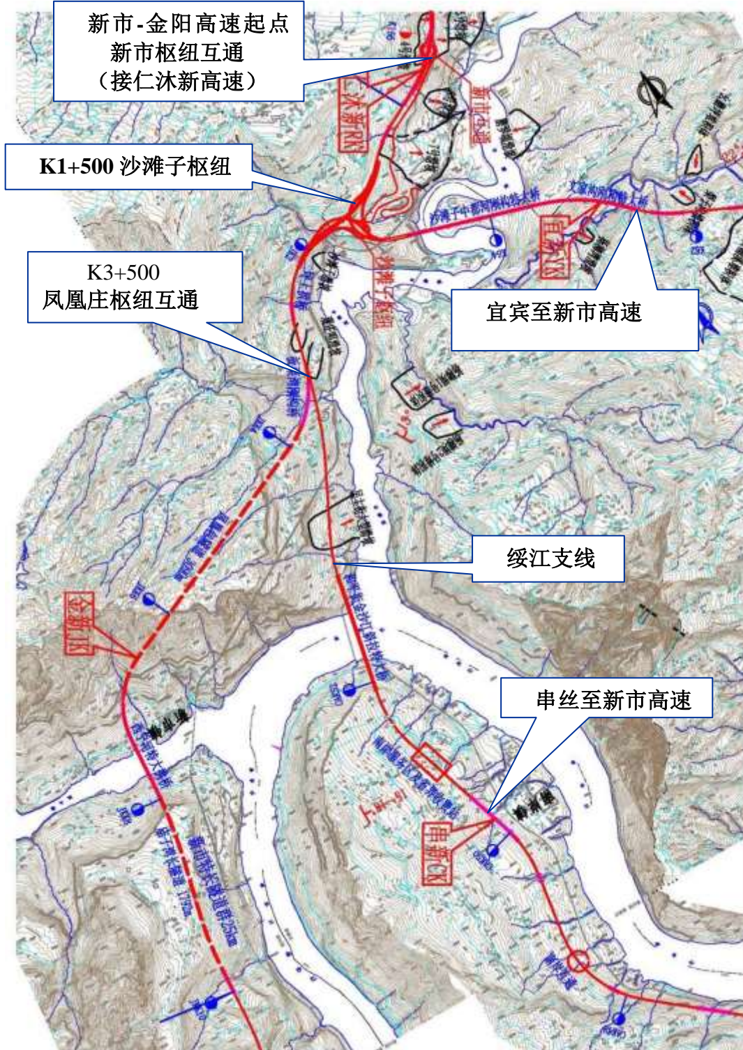
图 2.3-15 可研推荐（环评阶段）新市结点方案及各高速公路关系示意图
