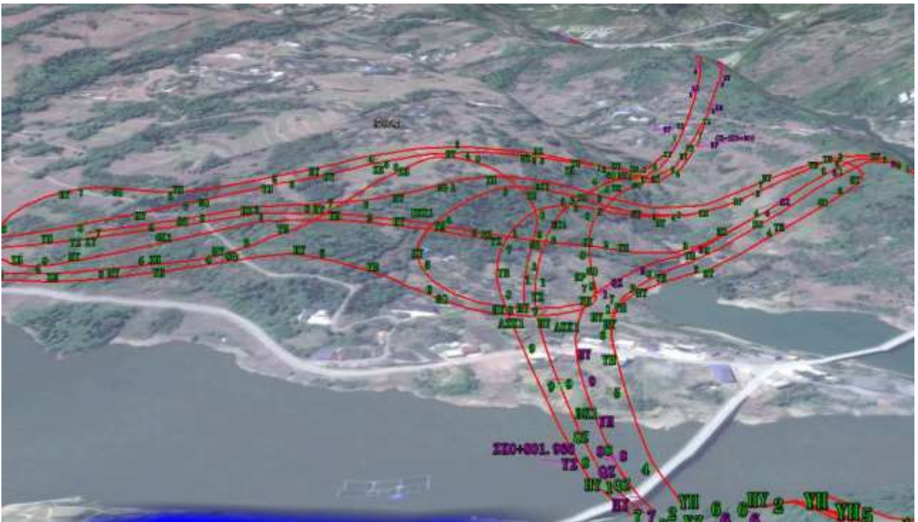
图 2.3-20 杨柳坝互通匝道桥布置及区域地形条件
