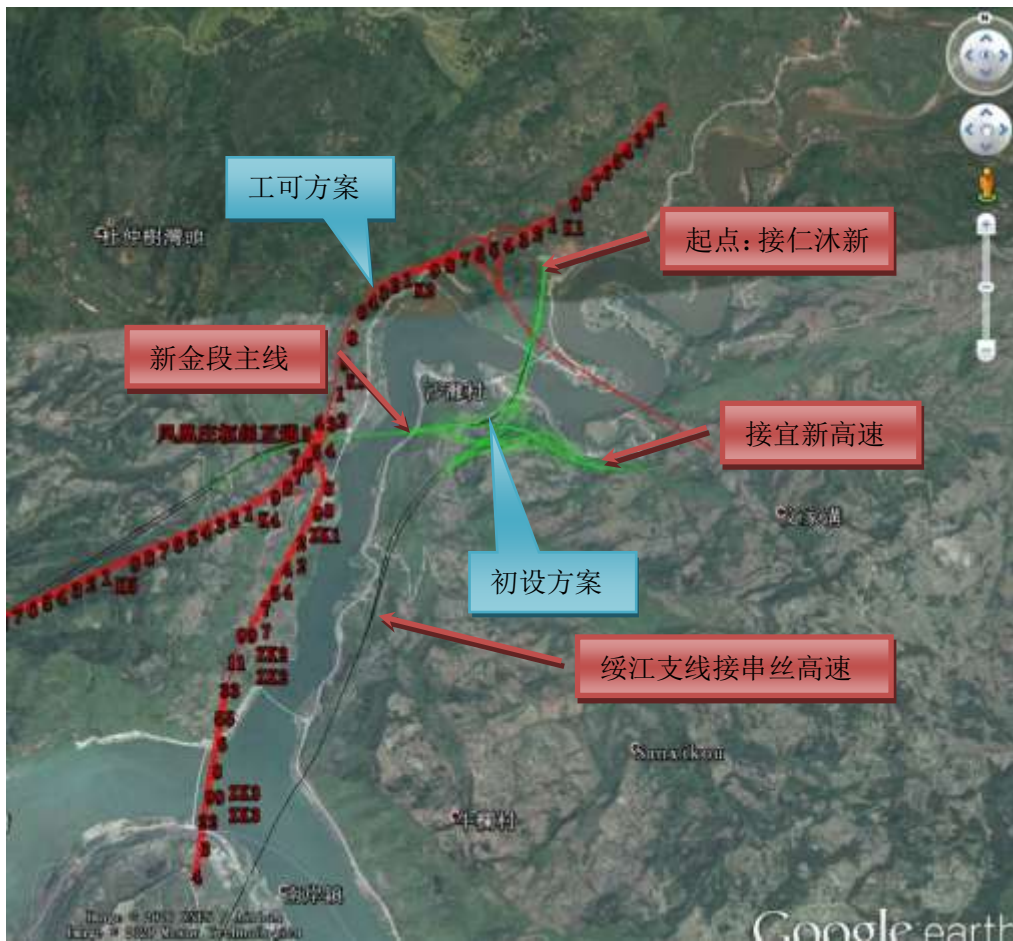
图 3.2-2 工可起点方案与初设起点互通方案对比示意图
